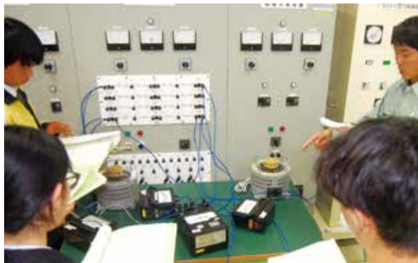
模擬送電線実習(電力ネットワークのしくみを学習)
