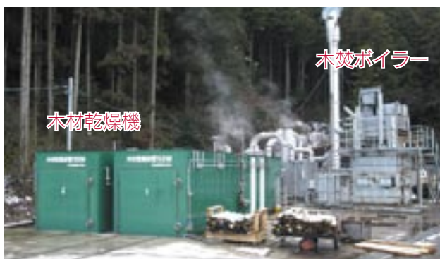
製材工場で稼働する木質バイオマス利用の木材乾燥施設 (隠岐の島町)
