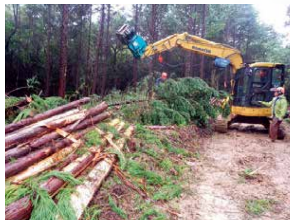
プロセッサによる玉伐り・枝払い作業
