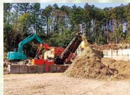
木材を破碎することにより、木質チップを生産(チップ生産業)
