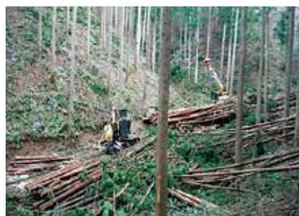
間伐木をスイングヤーダにより集材。 ハーベスタによる造材作業により間伐材を生産(間伐作業)
